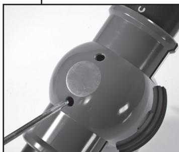
3. Pressione com cuidado os dois botões na lateral da parte inferior da tomada em carga para remover a parte superior da mesma. Retire o redutor para um tubo DN50 mm inserido na parte inferior da abraçadeira para tomada em carga.
