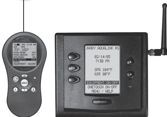
Se utilizar um sistema de controlo centralizado (ou controlador externo) para controlar a sua piscina, é necessário parametrizar o seu electrolisador Ei para permitir a comunicação entre os dois aparelhos.
